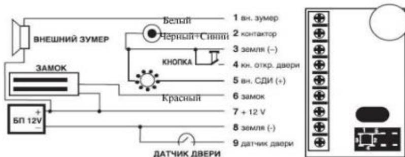
схема подключения контроллера
