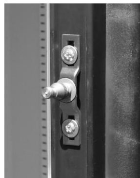
фото 1 Установка ригеля на остальные холодильники
